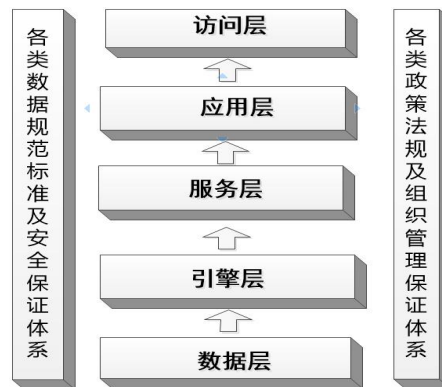
图 9.2.3 BIM 数据集成与管理平台系统架构简图
